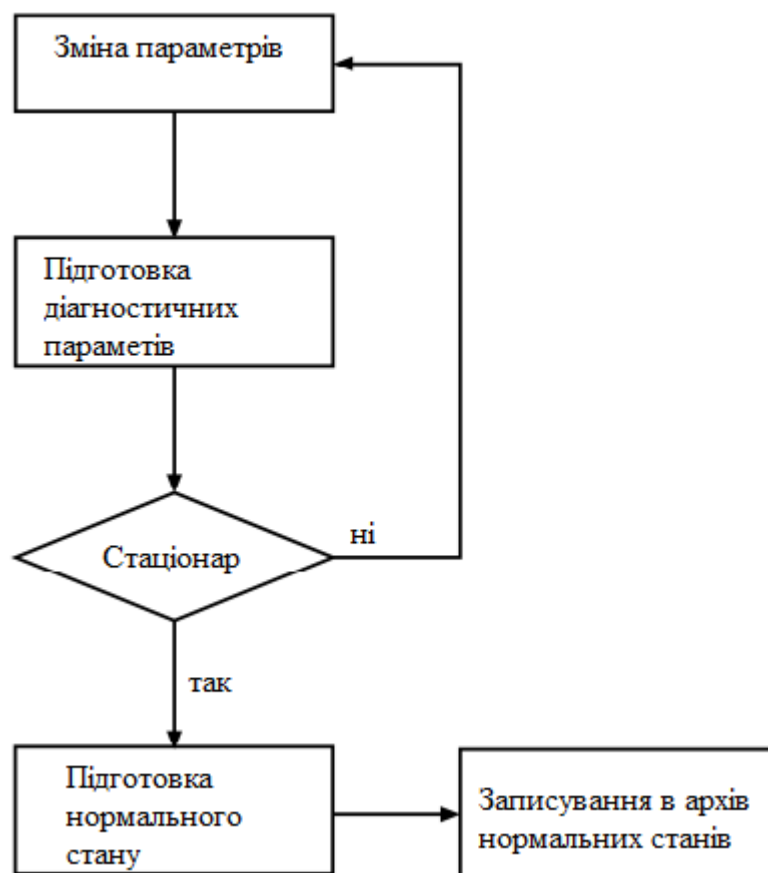
Рисунок 2.1 – Блок-схема підготовки нормального стану
