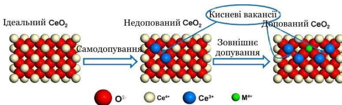
Рисунок 1.3 – Ємність зберігання кисню каталізатора \text{CeO}_2 . [5]
