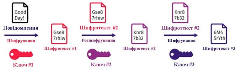
Рисунок 2.5. – Схема шифрування алгоритма 3DES
