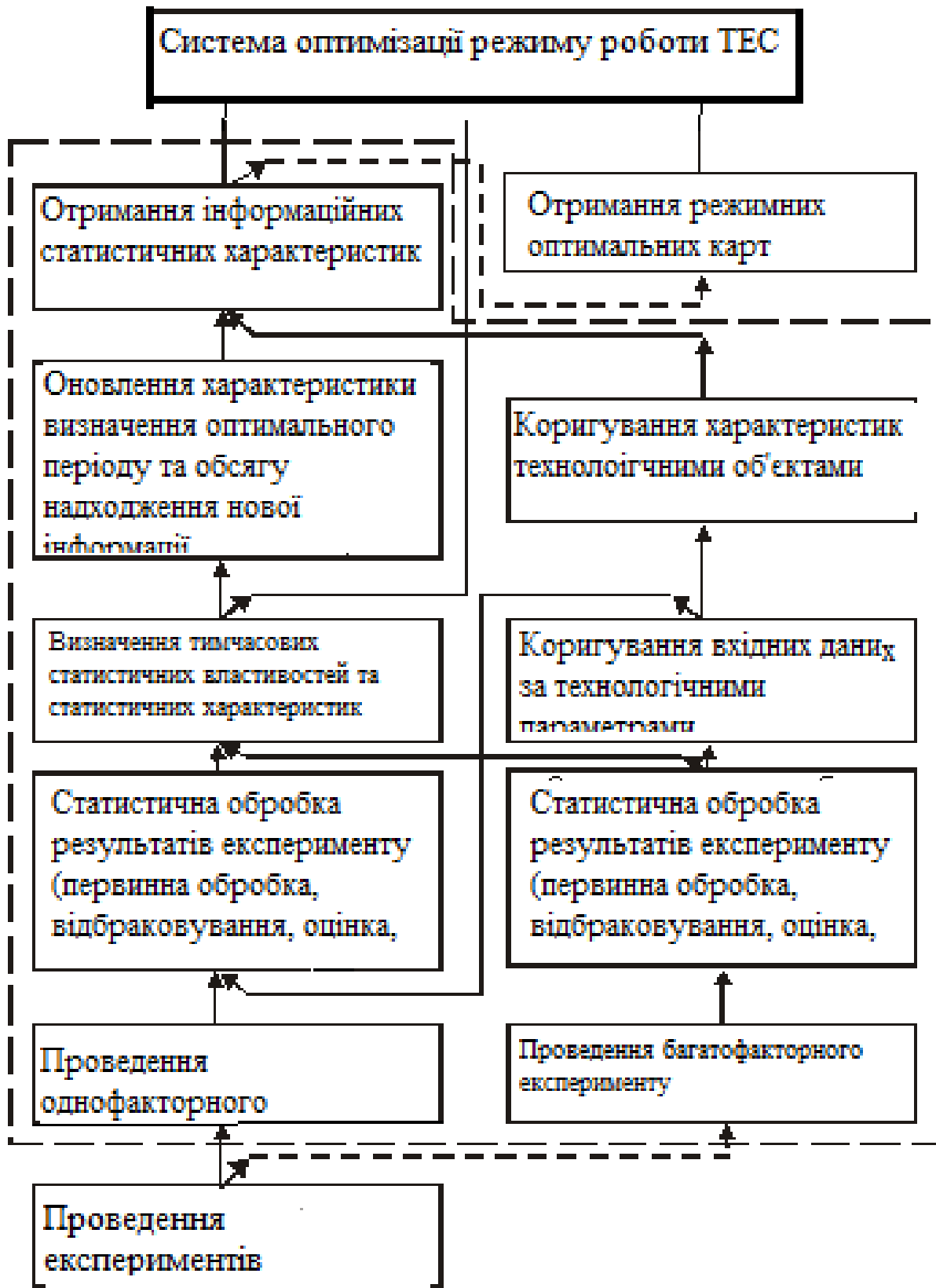
Рис. 1. Схема використання результатів експериментального визначення енергетичних характеристик енергоблоку ТЕС
