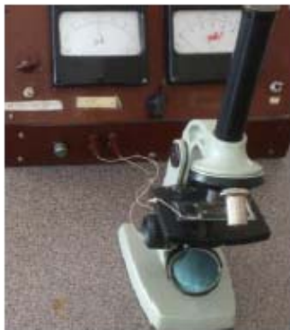
Рис. 3. Установка і камера для мікроелектрофорезу
