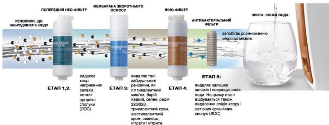
Рис. 1.5-Принцип роботи фільтра Zepter Edel Wasser
