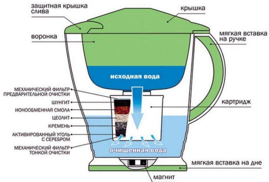
Рис. - 1.2 Конструкція кувшин-фільтра
