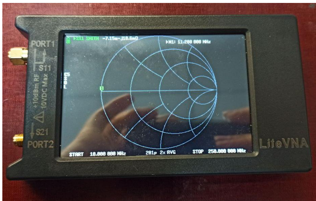
Рисунок 12 – Калібровка LiteVNA на короткозамкнутий порт 1.
