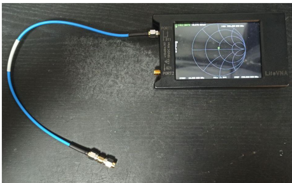
Рисунок 22 – Калібровка векторного аналізатора LiteVNA через коаксіальний кабель на навантаження 50 Ом
