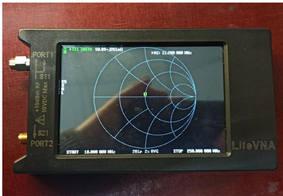
Рисунок 14 – Калібровка LiteVNA на навантаження 50 Ом на порті 1.
