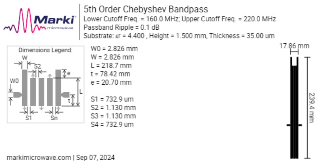
Рисунок 37 – Будова Interdigital фільтру 5-го порядку за допомогою калькулятора Marki Microwave
