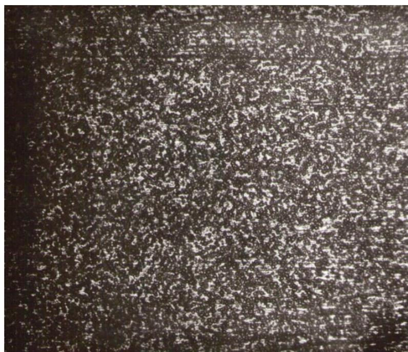
Рис. Б.11. Микрофотография медного осадка, полученного из раствора состава (моль/дм<sup>3</sup>): 0,125 Cu(NO<sub>3</sub>)<sub>2</sub> + 0,01 HNO<sub>3</sub> + 0,005 лимонная кислота (рН 1,7;  $j_k = 2$  А/дм<sup>2</sup>;  $\delta = 5,9$  мкм) при увеличении 210
