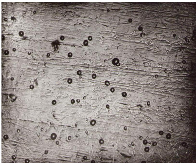
Рис. Б.16. Микрофотография медного осадка, полученного из раствора состава (моль/дм<sup>3</sup>): 0,125 Cu(NO<sub>3</sub>)<sub>2</sub> + 0,03 HNO<sub>3</sub> + 0,02 винная кислота (рН 1,5;  $j_k = 2$  А/дм<sup>2</sup>;  $\delta = 22,0$  мкм) при увеличении 210
