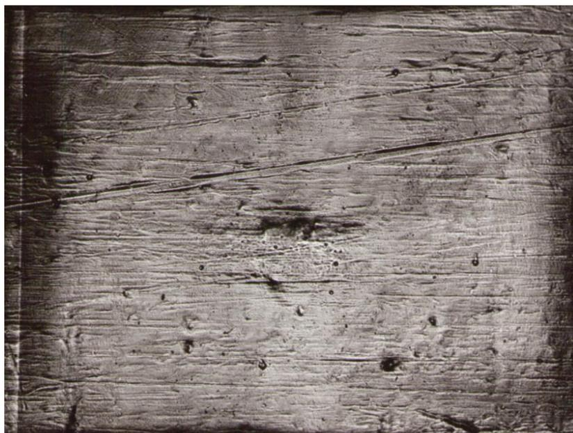
Рис. Б.10. Микрофотография медного осадка, полученного из раствора состава (моль/дм<sup>3</sup>): 0,125 Cu(NO<sub>3</sub>)<sub>2</sub> + 0,25 HNO<sub>3</sub> + 0,005 лимонная кислота (рН 0,9;  $j_k = 2$  А/дм<sup>2</sup>;  $\delta = 5,6$  мкм) при увеличении 210
