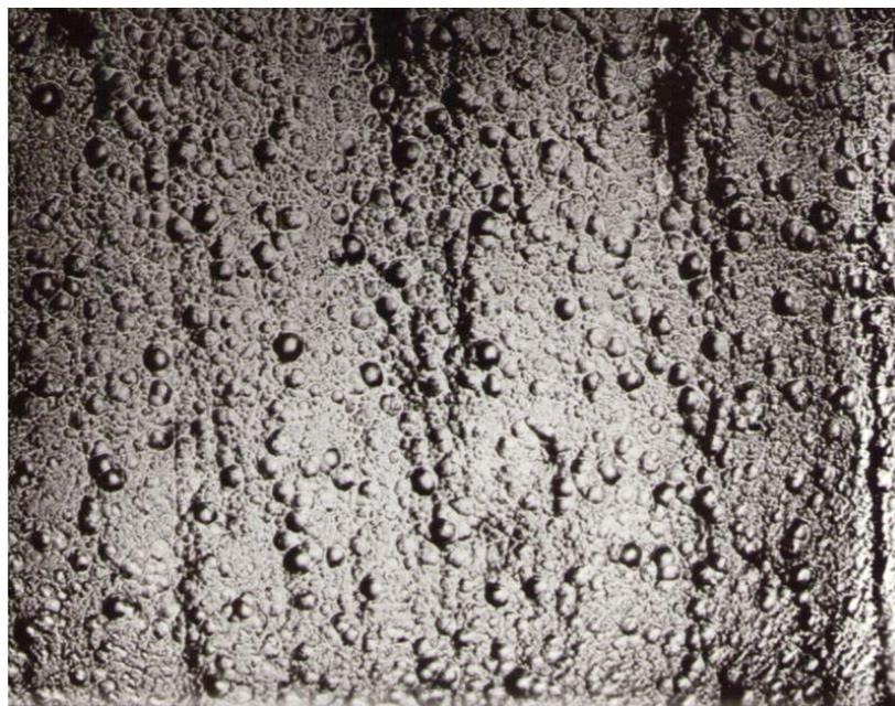
Рис. Б.21. Микрофотография медного осадка, полученного из раствора состава (моль/дм<sup>3</sup>): 0,125 Cu(NO<sub>3</sub>)<sub>2</sub> + 0,03 HNO<sub>3</sub> + 0,25 уксусная кислота (рН 1,5;  $j_{\kappa} = 2$  А/дм<sup>2</sup>;  $\delta = 32,0$  мкм) при увеличении 210
