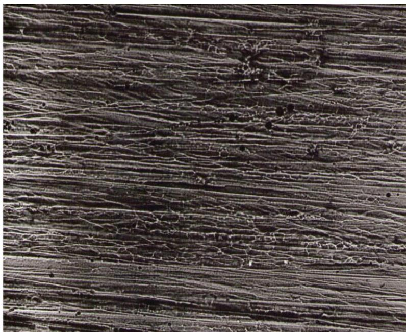
Рис. Б.14. Микрофотография медного осадка, полученного из раствора состава (моль/дм<sup>3</sup>): 0,125 Cu(NO<sub>3</sub>)<sub>2</sub> + 0,03 HNO<sub>3</sub> + 0,02 винная кислота (рН 1,5;  $j_k = 2$  А/дм<sup>2</sup>;  $\delta = 5,0$  мкм) при увеличении 210
