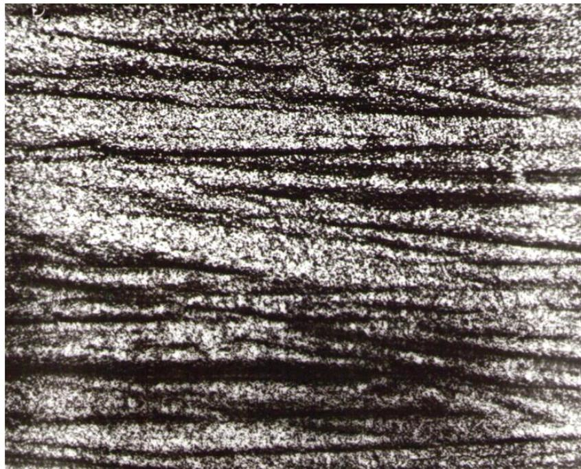
Рис. Б.13. Микрофотографии медного осадка, полученного из раствора состава (моль/дм<sup>3</sup>): 0,125 Cu(NO<sub>3</sub>)<sub>2</sub> + 0,25 HNO<sub>3</sub> + 0,125 H<sub>2</sub>SO<sub>4</sub> ( $j_k = 2$  А/дм<sup>2</sup>; рН = 0,9;  $\delta = 15$  мкм) при увеличении 210
