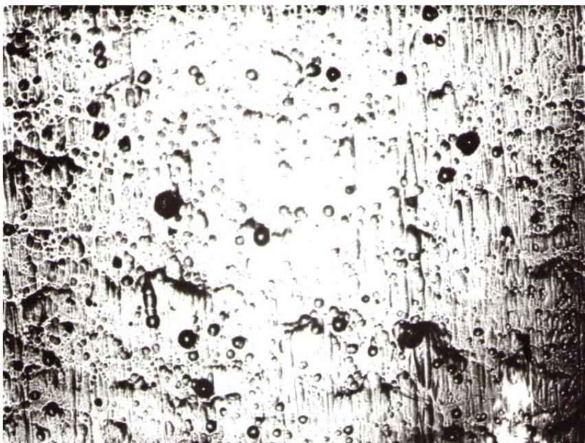
Рис. Б.18. Микрофотография медного осадка, полученного из раствора состава (моль/дм<sup>3</sup>): 0,125 Cu(NO<sub>3</sub>)<sub>2</sub> + 0,03 HNO<sub>3</sub> + 0,25 уксусная кислота (рН 1,5;  $j_k = 2$  А/дм<sup>2</sup>;  $\delta = 11,0$  мкм) при увеличении 210
