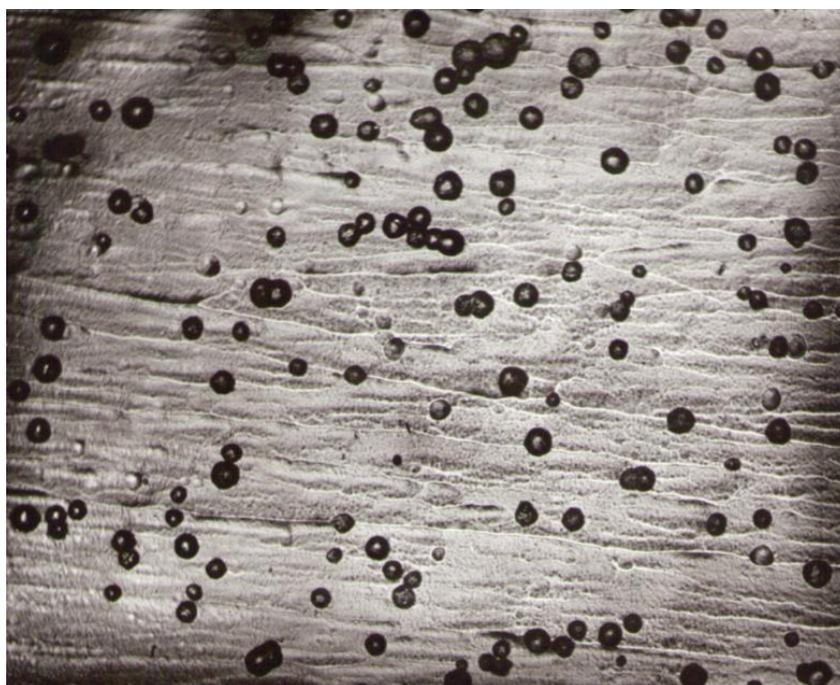
Рис. Б.17. Микрофотография медного осадка, полученного из раствора состава (моль/дм<sup>3</sup>): 0,125 Cu(NO<sub>3</sub>)<sub>2</sub> + 0,03 HNO<sub>3</sub> + 0,02 винная кислота (рН 1,5;  $j_k = 2$  А/дм<sup>2</sup>;  $\delta = 33,0$  мкм) при увеличении 210
