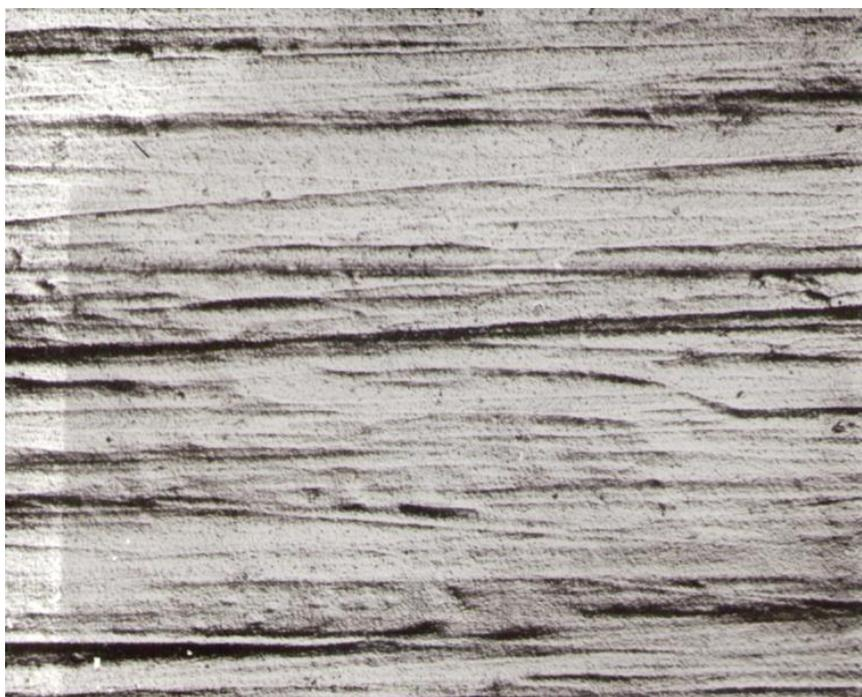
Рис. Б.19. Микрофотография медного осадка, полученного из раствора состава (моль/дм<sup>3</sup>): 0,125 Cu(NO<sub>3</sub>)<sub>2</sub> + 0,03 HNO<sub>3</sub> + 0,25 уксусная кислота + 0,1г/дм<sup>3</sup> ОП-7 (рН 1,5;  $j_k = 2$  А/дм<sup>2</sup>;  $\delta = 10,0$  мкм) при увеличении 210
