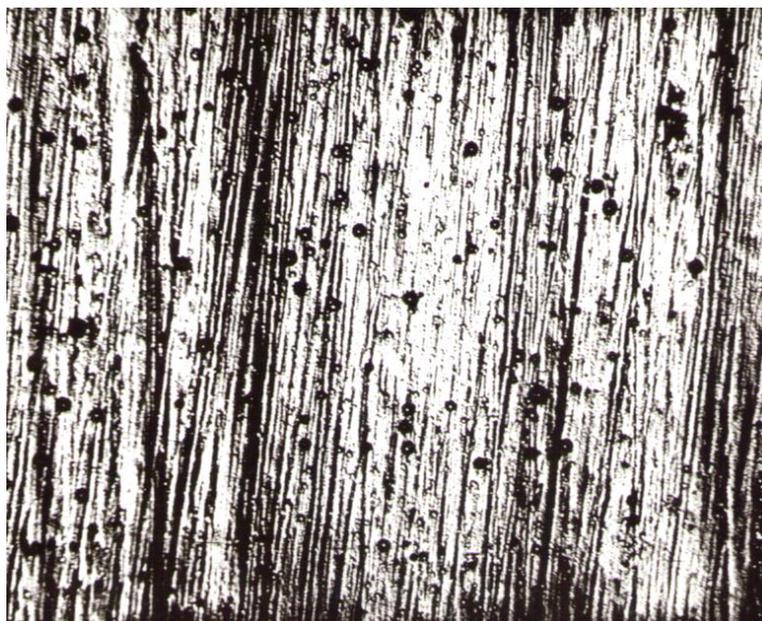
Рис. Б.6. Микрофотография медного осадка, полученного из раствора состава (моль/дм<sup>3</sup>): 0,125 Cu(NO<sub>3</sub>)<sub>2</sub> + 0,03 HNO<sub>3</sub> + 0,005 трилон Б (рН 1,5;  $j_k = 2$  А/дм<sup>2</sup>;  $\delta = 13,0$  мкм) при увеличении 210
