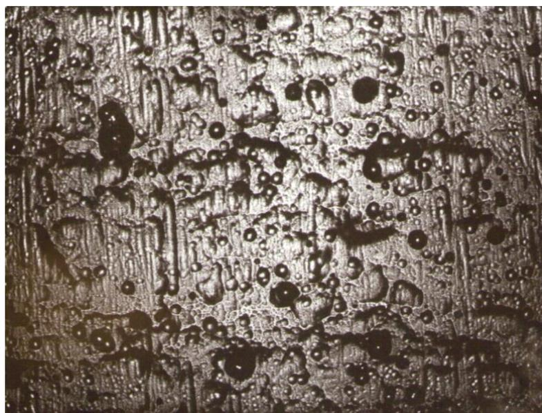
Рис. Б.7. Микрофотография медного осадка, полученного из раствора состава (моль/дм<sup>3</sup>): 0,125 Cu(NO<sub>3</sub>)<sub>2</sub> + 0,03 HNO<sub>3</sub> + 0,005 трилон Б (рН 1,5;  $j_k = 2$  А/дм<sup>2</sup>;  $\delta = 19,0$  мкм) при увеличении 210
