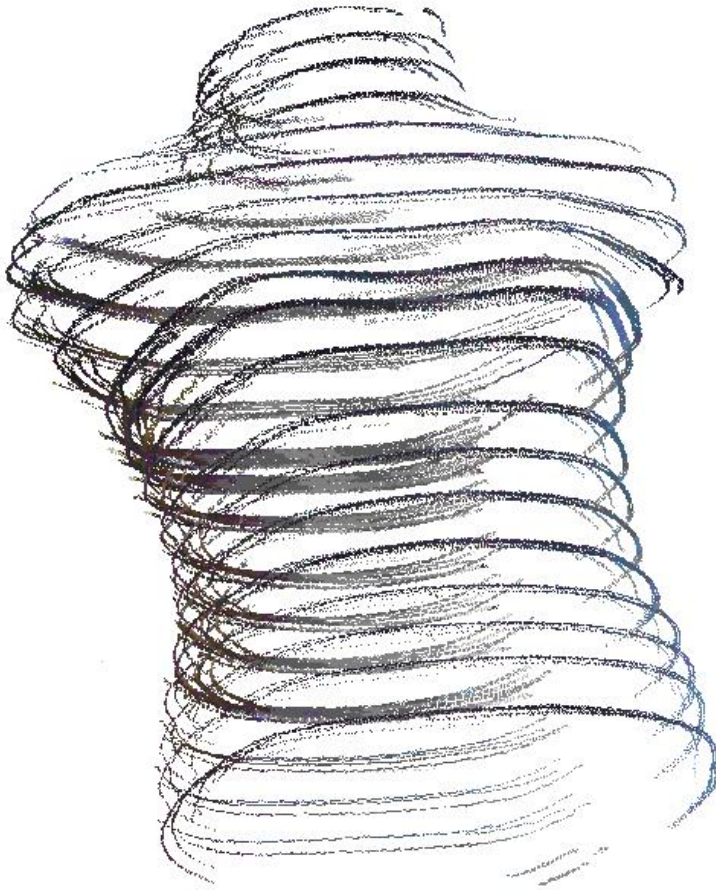
Рис.3.25. Розбиття поверхні поперечними перетинами
