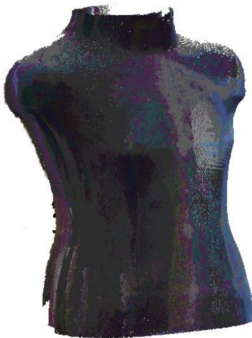
Рис.3.24. Поверхня точок, отримана за допомогою 3D сканера
