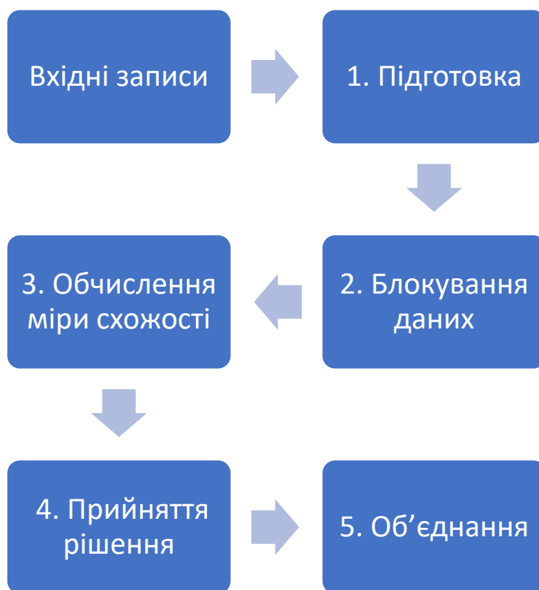
Рисунка 3.4 – Алгоритмічна схема fuzzy matching .
