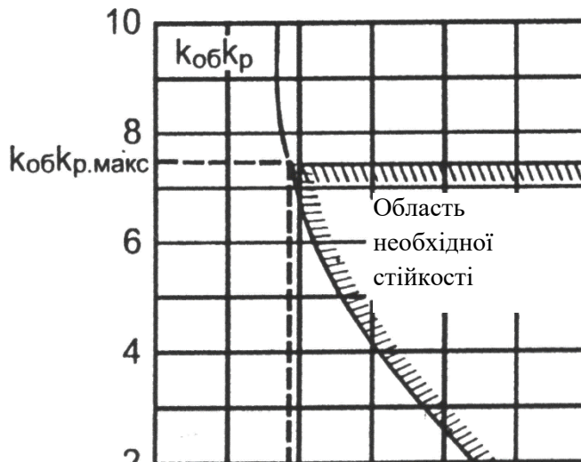
Рисунок 1.7 – Визначення точки оптимальної настройки ПІ – регулятора в площині його параметрів настройки.
