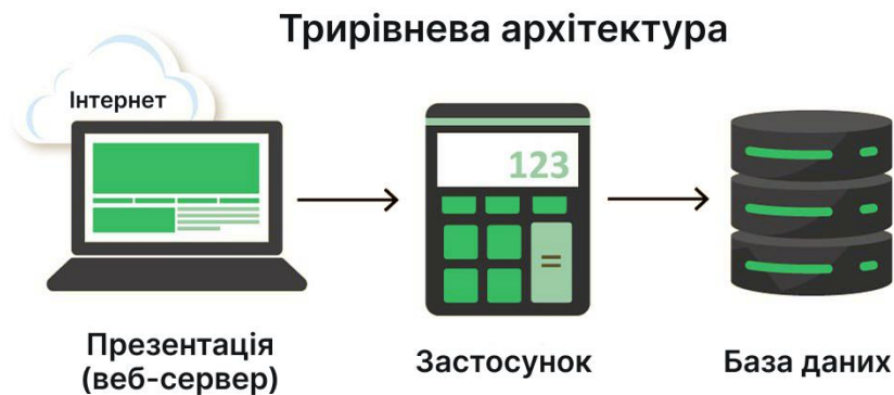
Рисунок 2.3 – Схема трирівневої архітектури [9]
