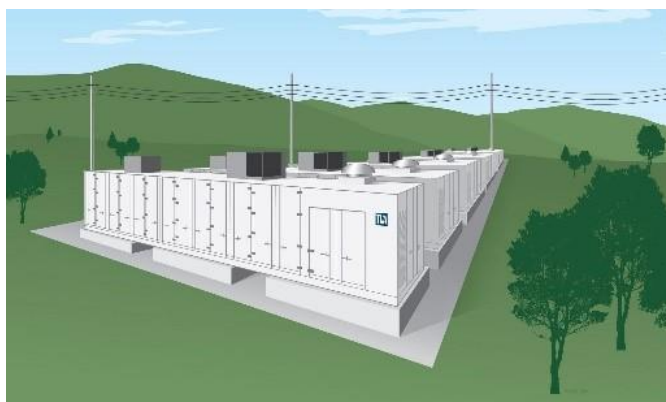
Рисунок 1.1 - Система зберігання енергії на базі акумуляторних батарей
