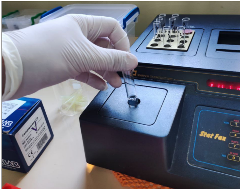
Рис. 2.3 Процес отримання значень поглинання на біохімічному аналізаторі StatFax 1904
