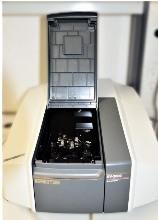
Рис. 2.4 Спектрофотометр Shimadzu UV-2600. Джерело: https://zaf.th-deg.de/public/machine/78
