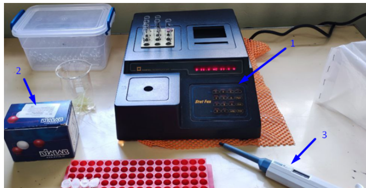
Рис. 2.2 Використовуване для методу обладнання: 1 – біохімічний аналізатор StatFax 1904; 2 – набір Dialab, Австрія; 3 – дозатор автоматичний
