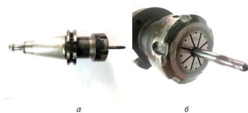
Рисунок 5.8 – Патрон TC40H70ER32AD-B(а) та цангу ER32(б)
