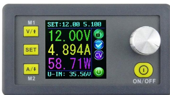
Рисунок 2.3 – Одноканальний лабораторний блок живлення
