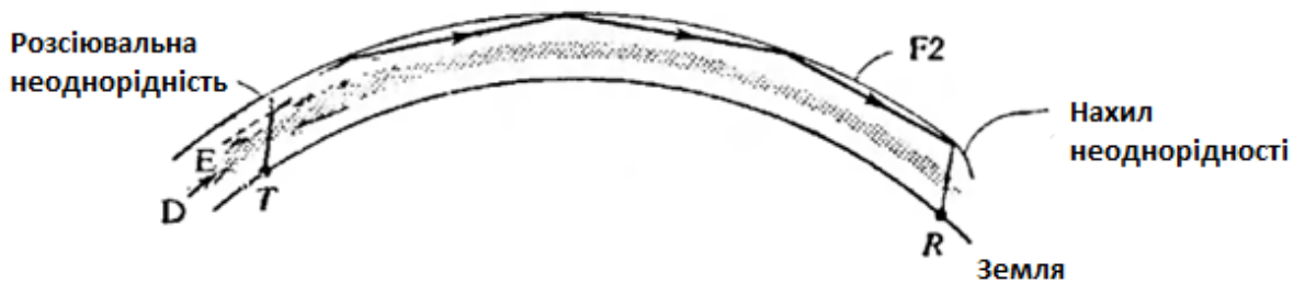
Рис. 1.6. Променева траєкторія за участю розсіяння, за яким слідує ряд відбиттів від шару F. Таку траєкторію можна позначити символом EFFFF.
