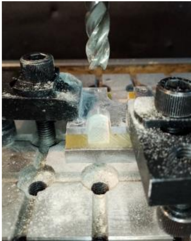
Рисунок 4.1 – Зона обробки при фрезеруванні з притискною пластиною
