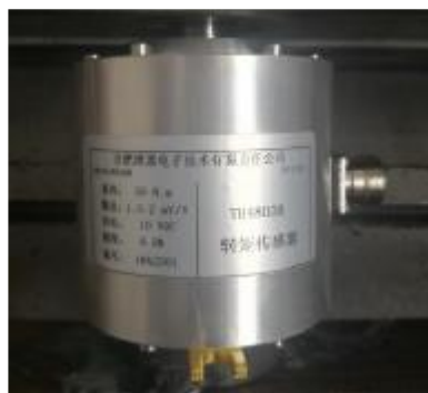
Рисунок 3.2 – П'єзоелектричний датчик динамічного моменту, що крутить, компанії China Botong Electric
