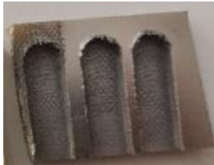
Рисунок 2.9 – Експериментальний зразок із нанесеним покриттям (Au-Pd)
