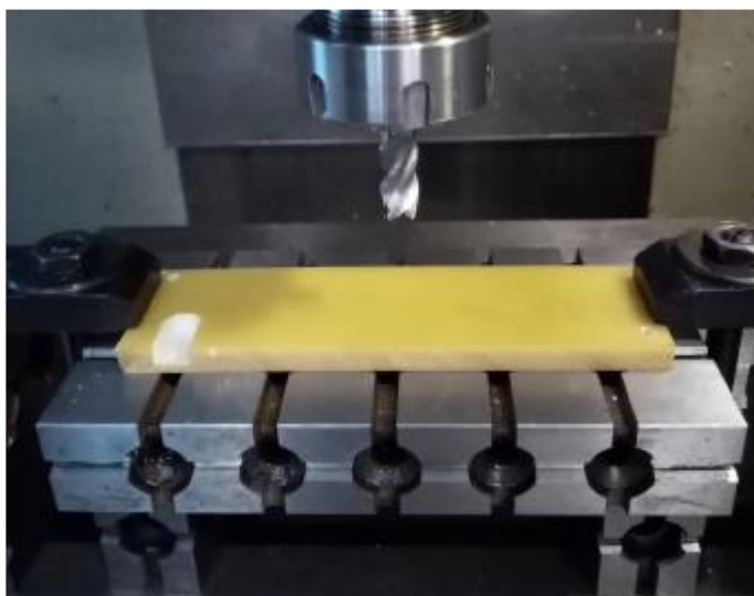
Рисунок 4.3 – Кінцеве фрезерування без притискної пластини
