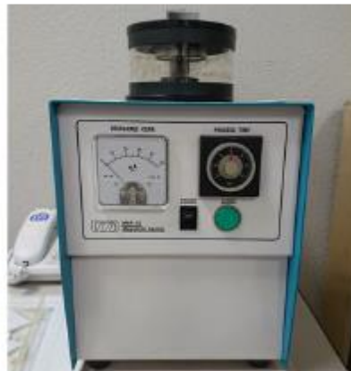
Рисунок 2.3 – Вакуумний апарат для магнетронного напилення MSP-1S
