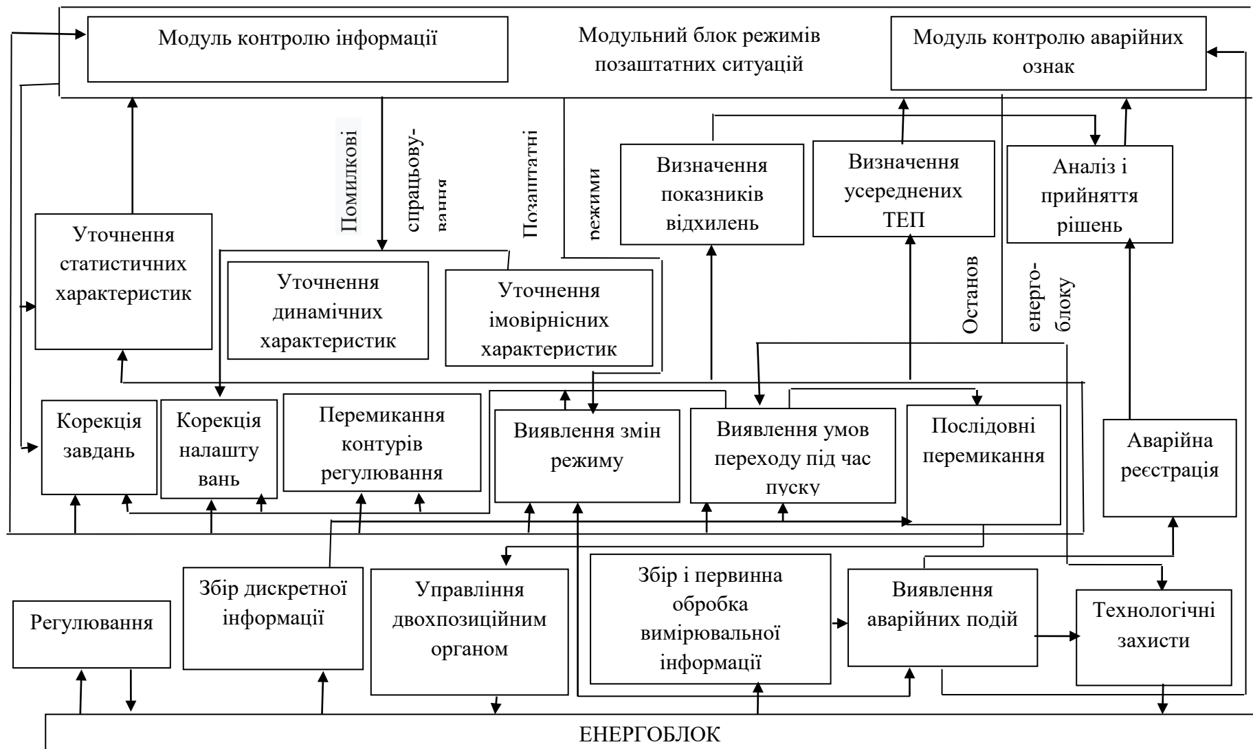
Рисунок 2.4 – Інформаційно-алгоритмічна схема АСУТП енергоблоку при функціонуванні електроенергетичного обладнання в позаштатних режимах
