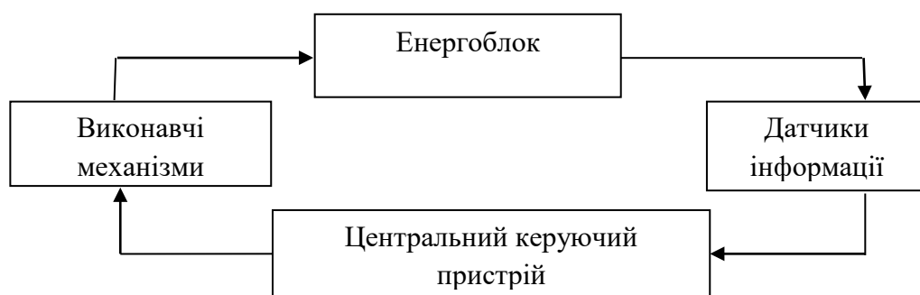
Рисунок 2.1 – Варіант структурної схеми АСУТП енергоблоку з повністю централізованою системою обробки інформації в штатному режимі функціонування
