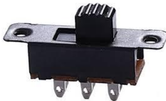
Рисунок 2.9 – Повзунковий перемикач режимів роботи (ручний / автоматичний)
