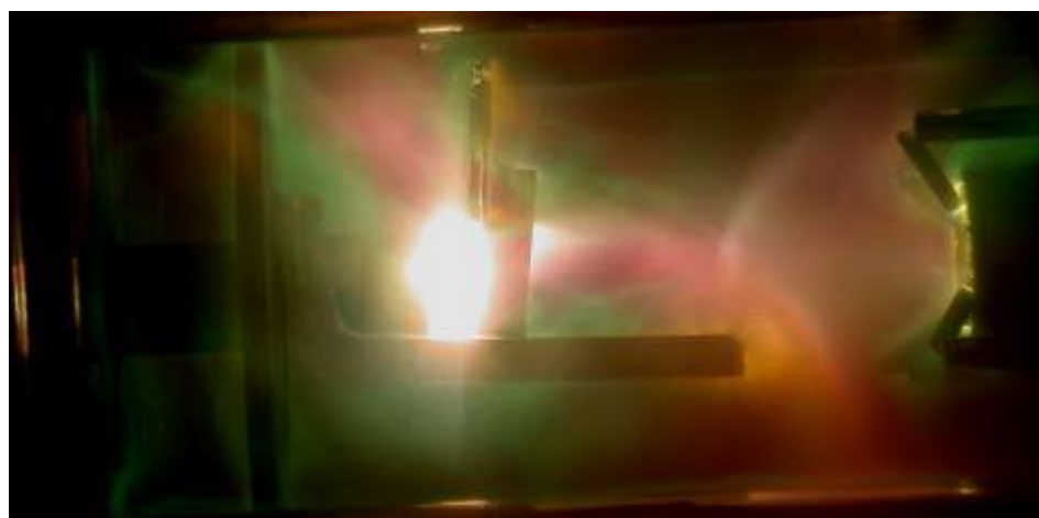
Рис. 3.7. Фотографія розрядного проміжку в момент опромінення зразка
