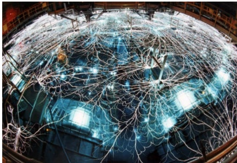
Рис. 1.1. Фотографія установки PBFA-II під час розряду [19]
