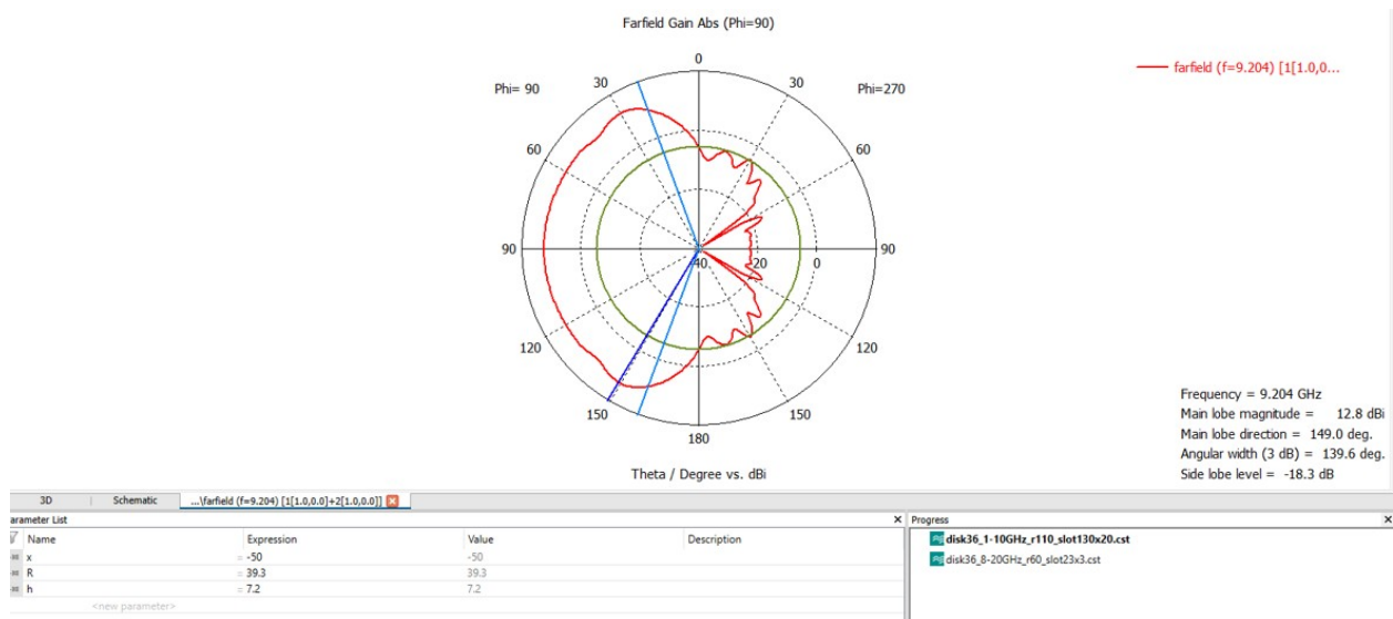
Рис 24: Діаграма напрямленості 9.204 ГГц
