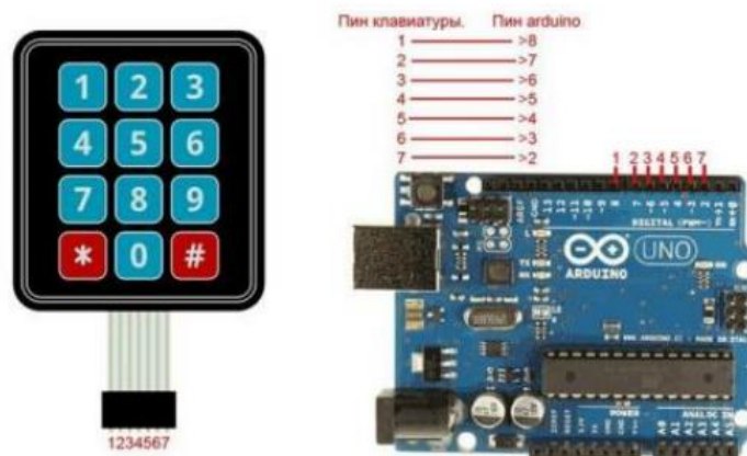
Рис. 2. Схема підключення матричної клавіатури
