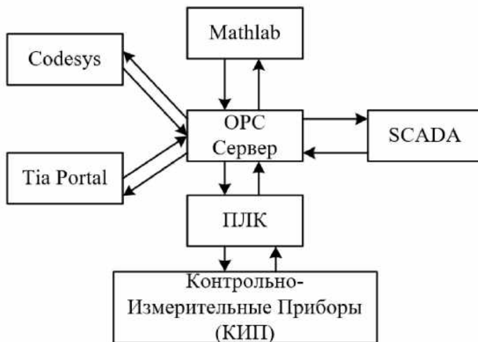
Рисунок 5 – Взаємозв'язок елементів АСУ ТП установки зворотного осмосу.
