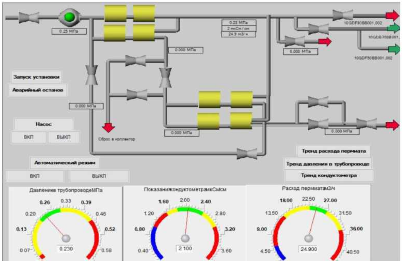
Рисунок 38 – SCADA система водопідготовчої установки GDF71
