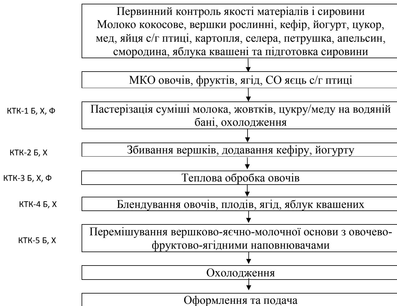
Рисунок 3.2 – Принципова блок-схема морозива із визначенням критичних точок контролю
