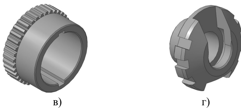
Рисунок 5.3 - Твёрдотельные модели деталей: а – гильза; б – фланец; в – напівмуфта; г - гайка
