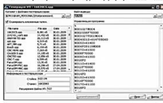
Приклад отриманої керуючої програми за допомогою системи Solid Works
