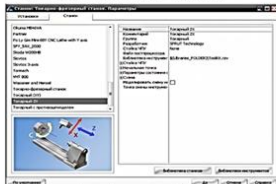
Задання параметрів до вибору верстату з ЧПК у програмі Solid Works
