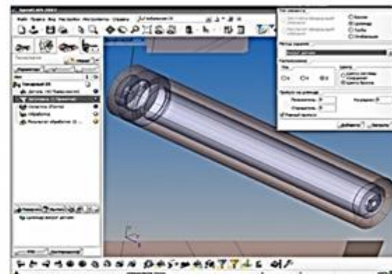
Задання форми заготовки до деталі у програмі Solid Works
