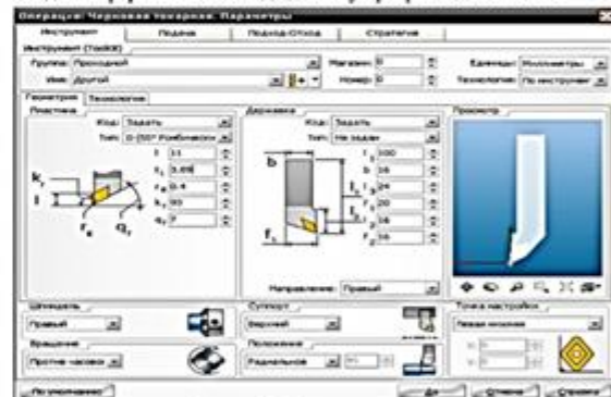
Задання параметрів та вибір інструменту у програмі Solid Works
