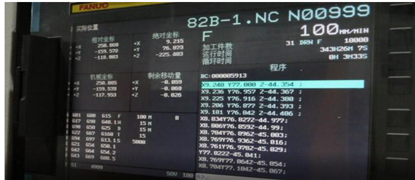
Рисунок 3.3 - Перелік кодів елементів деталі «Вал»
