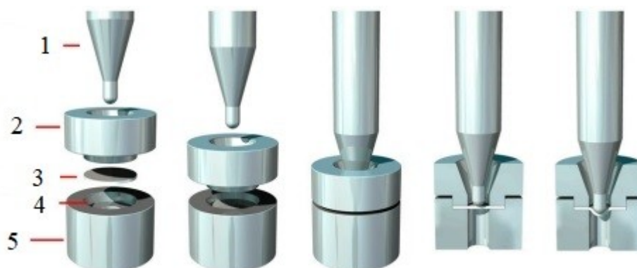
Рис. 6. Схематичне зображення методу. 1 – напівсферичні головка ударника, 2 – верхня матриця, 3 – мініатюрний диск, 4 – приймальний отвір, 5 – нижня матриця
