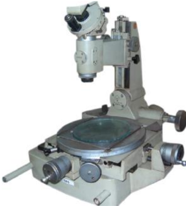
Малюнок 3.8 – Інструментальний мікроскоп БМІ-1
