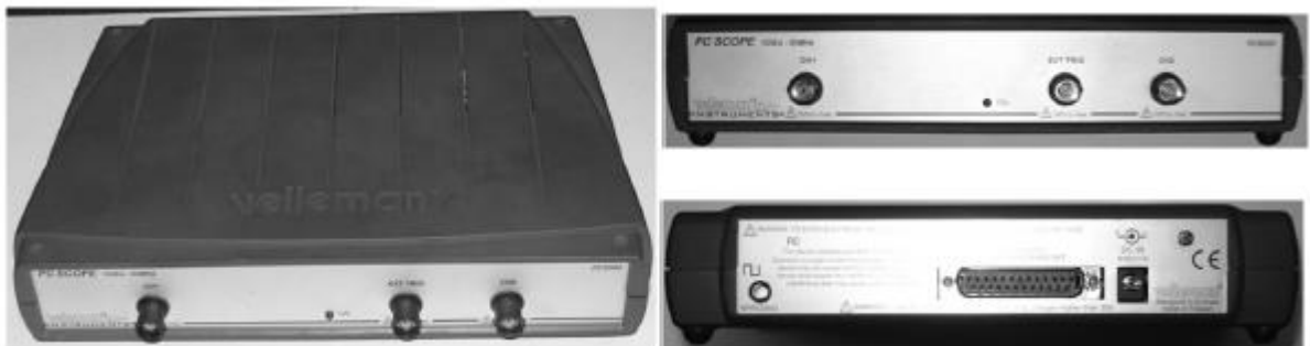
Рисунок 3.5 – Цифровий осцилограф Velleman моделі PCS500
