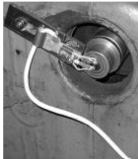
Рисунок 3.3 – Загальний вигляд та конструктивне виконання струмознімач
