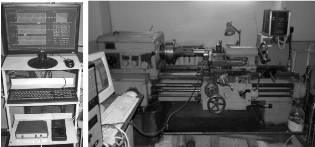
Рисунок 3.1 – Загальний вигляд експериментальної установки на базі токарно-гвинторізного верстата 1К62
