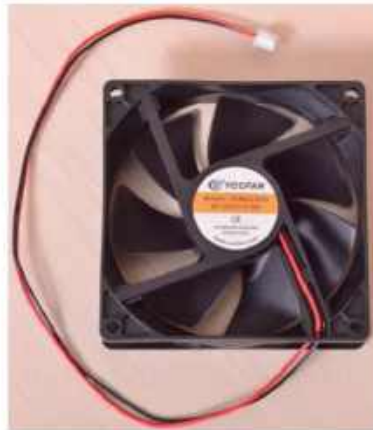
Рисунок 23 – Вентилятор у зволожувачі повітря Par-Tuman ГТ-1,6 Живлення вентилятора здійснюється напругою 32 В та струмом 0,12 А [32 - 34].
