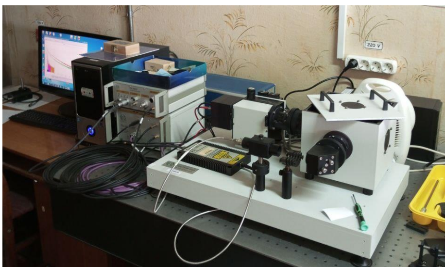
Рисунок 2.2. Спектрофлуориметр Fluotime 200. Фото зроблено в лабораторії Інституту сцинтиляційних матеріалів НАН України.
