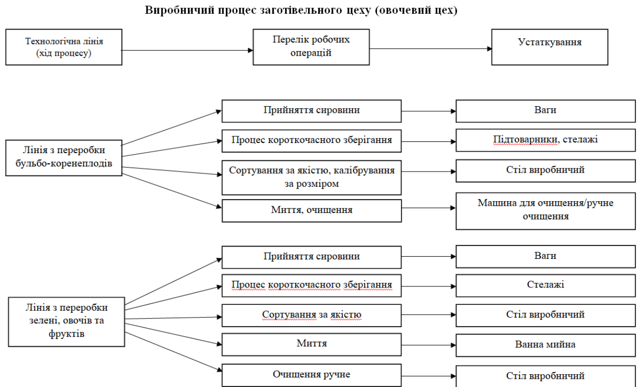
Рис 2.1 Технологічні лінії овочевого цеху
