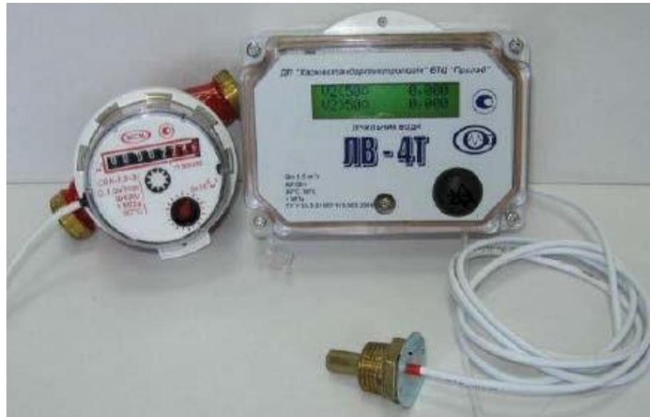
Рисунок 2.7 Контрольно-вимірювальний механізм температури і розливу води
