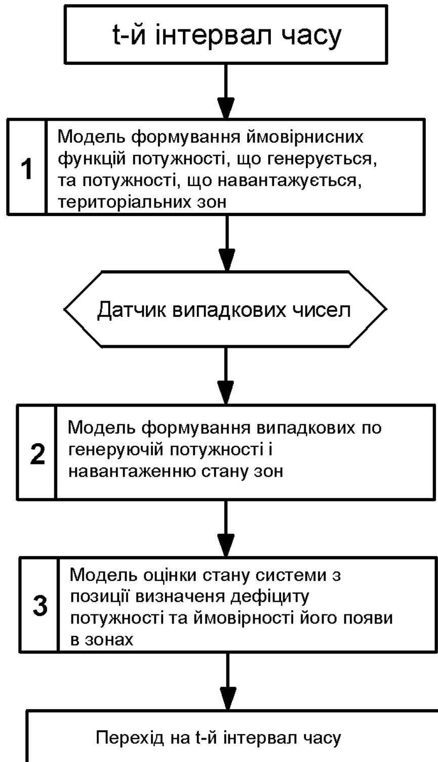
Рисунок 3.9. - Фрагмент укрупненої блок-схеми моделі оцінки показників надійності ЕЕС
