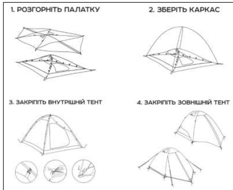
Рис. 2.8. Інструкція встановлення намету [42]
