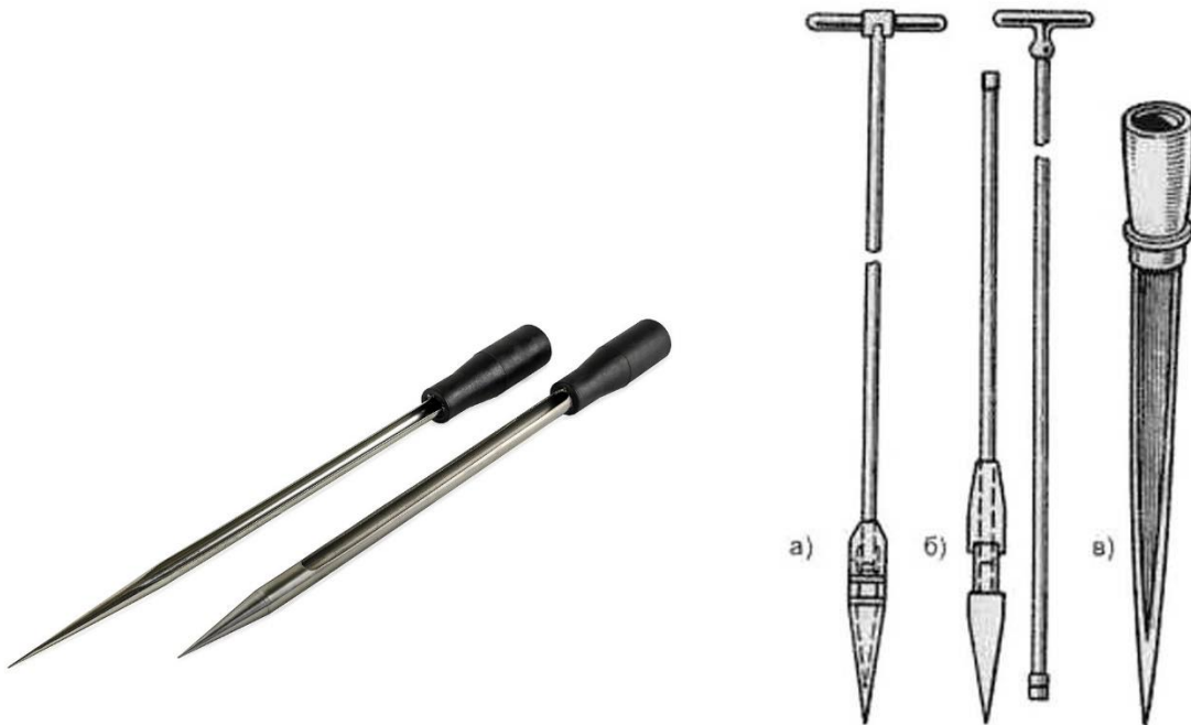
Мал. 10. Щупи: борошняний, а) автомобільний (вагонний), б) складський (комірний) та в) мішечний.
