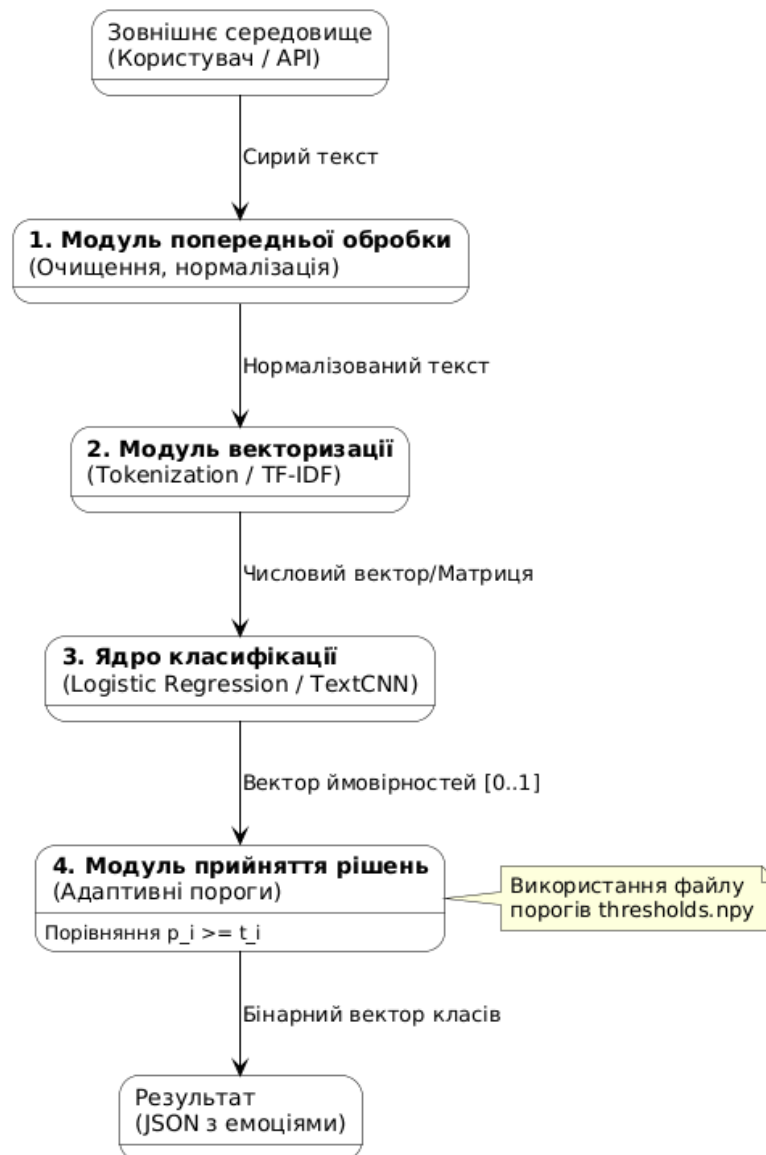
Рисунок 2.1 — Структурна схема автоматизованої системи аналізу емоцій.
