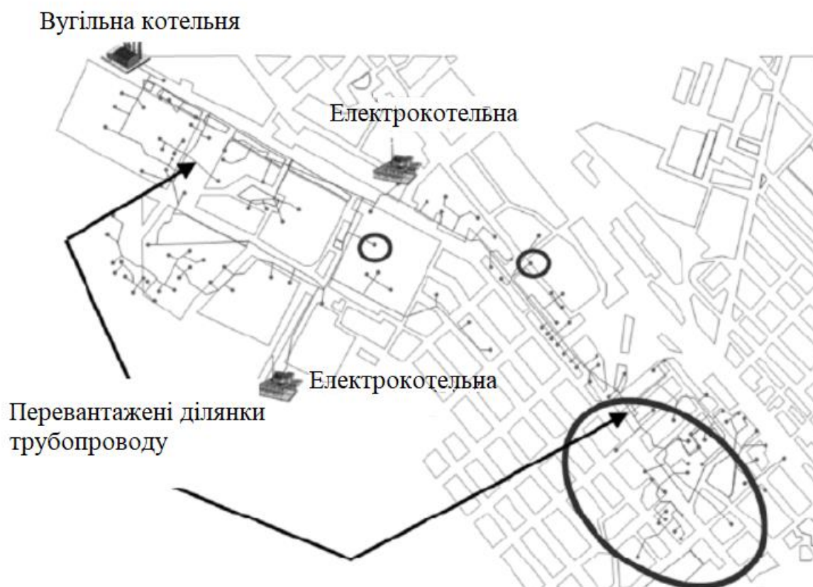
Рисунок 1.4 – Схема інтегрованої енергетичної системи на прикладі району міста
