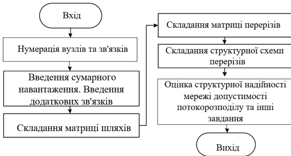
Рисунок 2.9 – Алгоритм методу шляхів та перерізів при оцінці структурної надійності схеми енергопостачання
