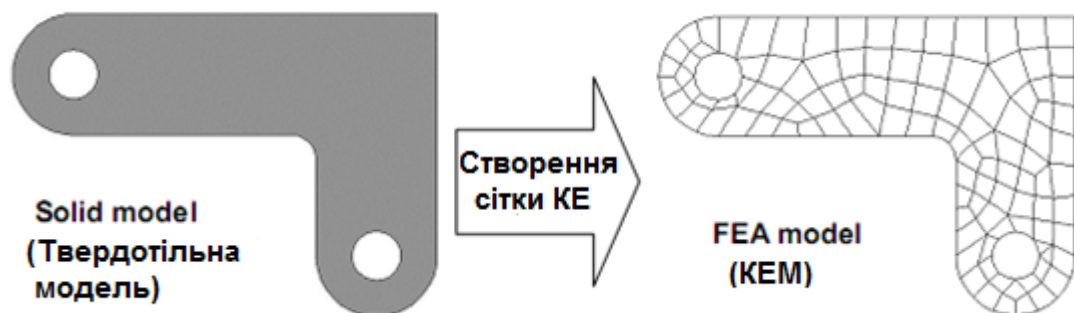
Рисунок 5.5 - Створення сітки KE
