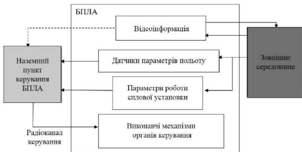
Рисунок 2.1 – схема взаємодії компонентів системи БПЛА.
