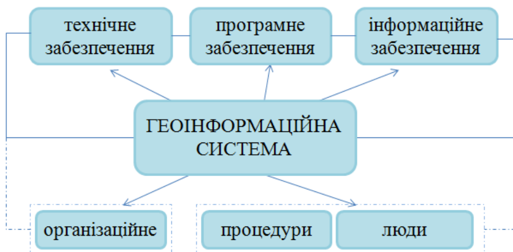
Рис. 1.1. Компонентна структурна модель ГІС (суцільними лініями позначені базові елементи)
