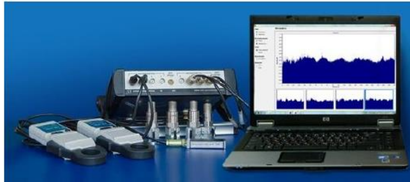
Рисунок 3.1 - Мережеві вимірювачі з комп'ютером та встановленою технологічною програмою
