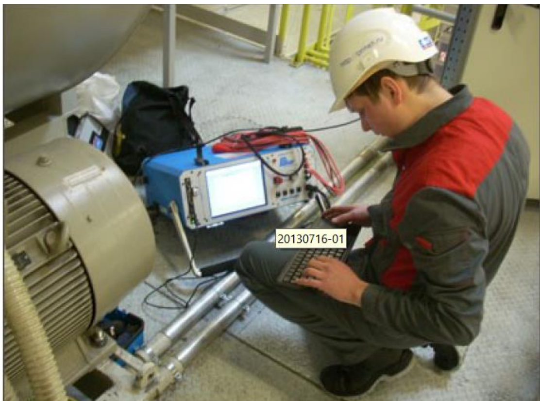
Рисунок 2.2 - Зняття параметрів струму з електродвигуна
