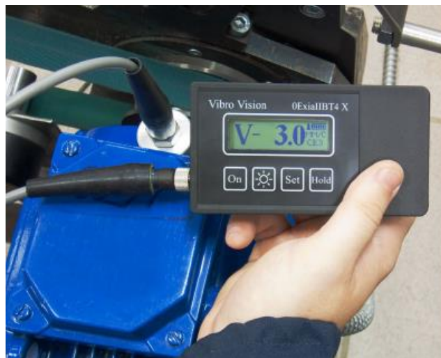
Рисунок 2.1 - Зняття показань вібрації на електродвигуні
