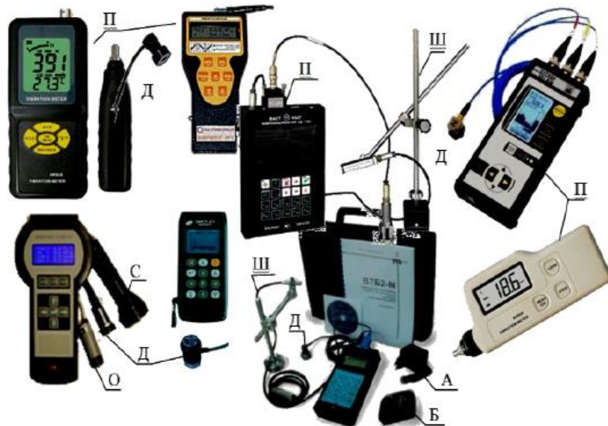
Рисунок 2.7 - Малогабаритні вимірювачі вібрації: А – мережний адаптер (зарядний пристрій); Б - акумуляторна батарея; П – прилад; Д – датчик вібрації; С – стробоскоп; О – оптичний датчик; Ш – настановна шпилька з магнітним утримувачем
