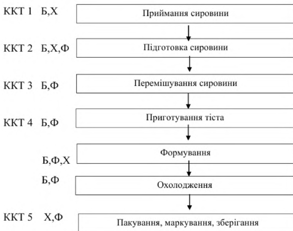
Рис. 3.2 – Блок-схема технологічного процесу виробництва сирників СПСС
