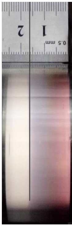
Рис.2.2. Фотографія розряду для відстані між електродами 25 мм, тиску N_2O 0,05 Торр і струму 4,6 мА. Вертикальна лінія показує положення межі катодного шару.
