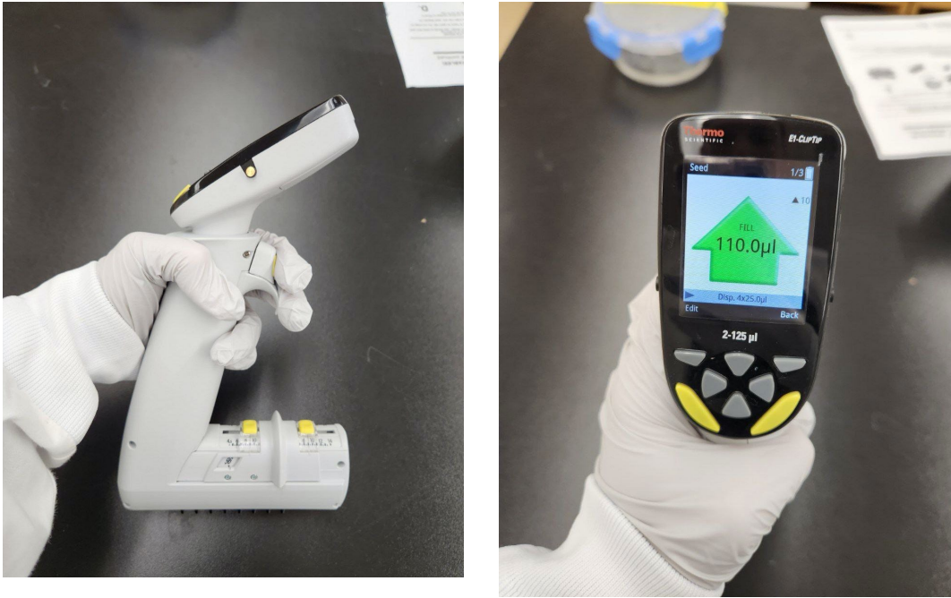
Рисунок 6.1 Автоматизована мультиканальна піпетка для висювання крапель суспензії клітин у 384-лунковий планшет для формування тривимірних культур.
