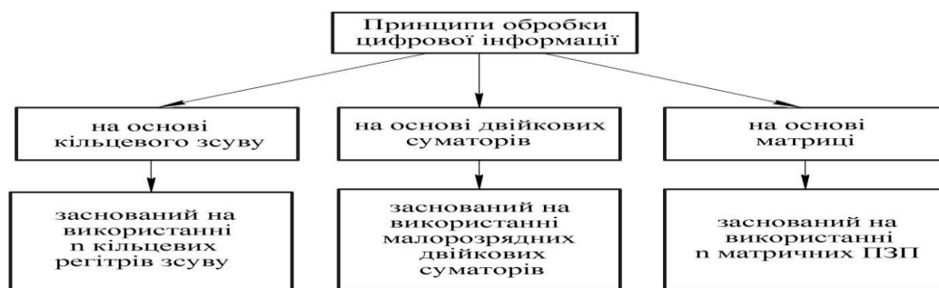
Рисунок 2.4 – Принципи обробки цифрової інформації
