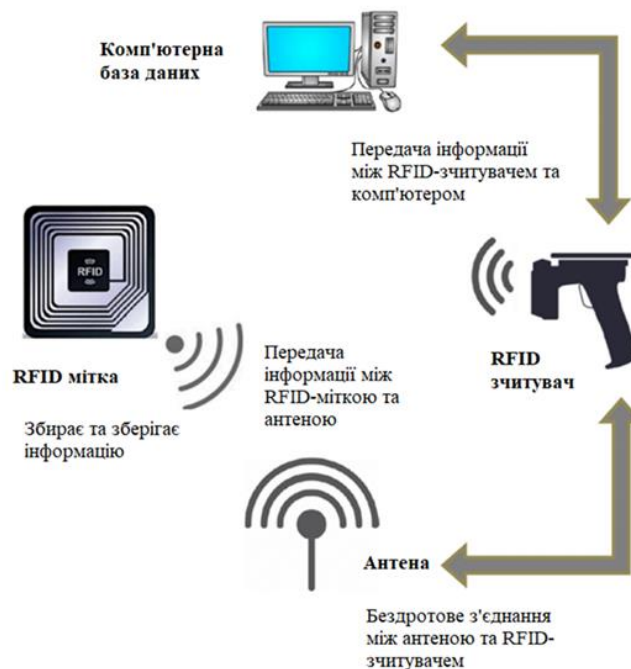
Рисунок 1.2 – Базова RFID система
