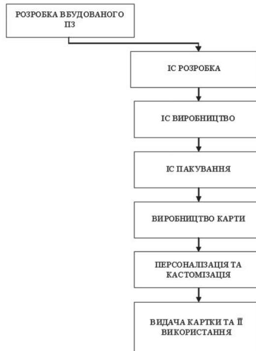
Рисунок 3.1 – Життєвий цикл виробництва смарт-картки
