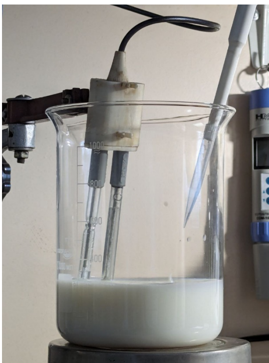
Рис. 2.3. Процес зміщення ізоелектричної точки знежиреного молозива шляхом поступового додавання 1Н розчину оцтової кислоти.
