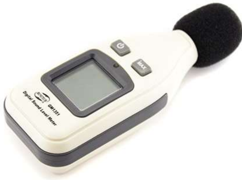
Рис. 2.1 – Прилад для вимірювання рівнів звукового тиску та звуку: шумомір портативний GM 1351 [20]
