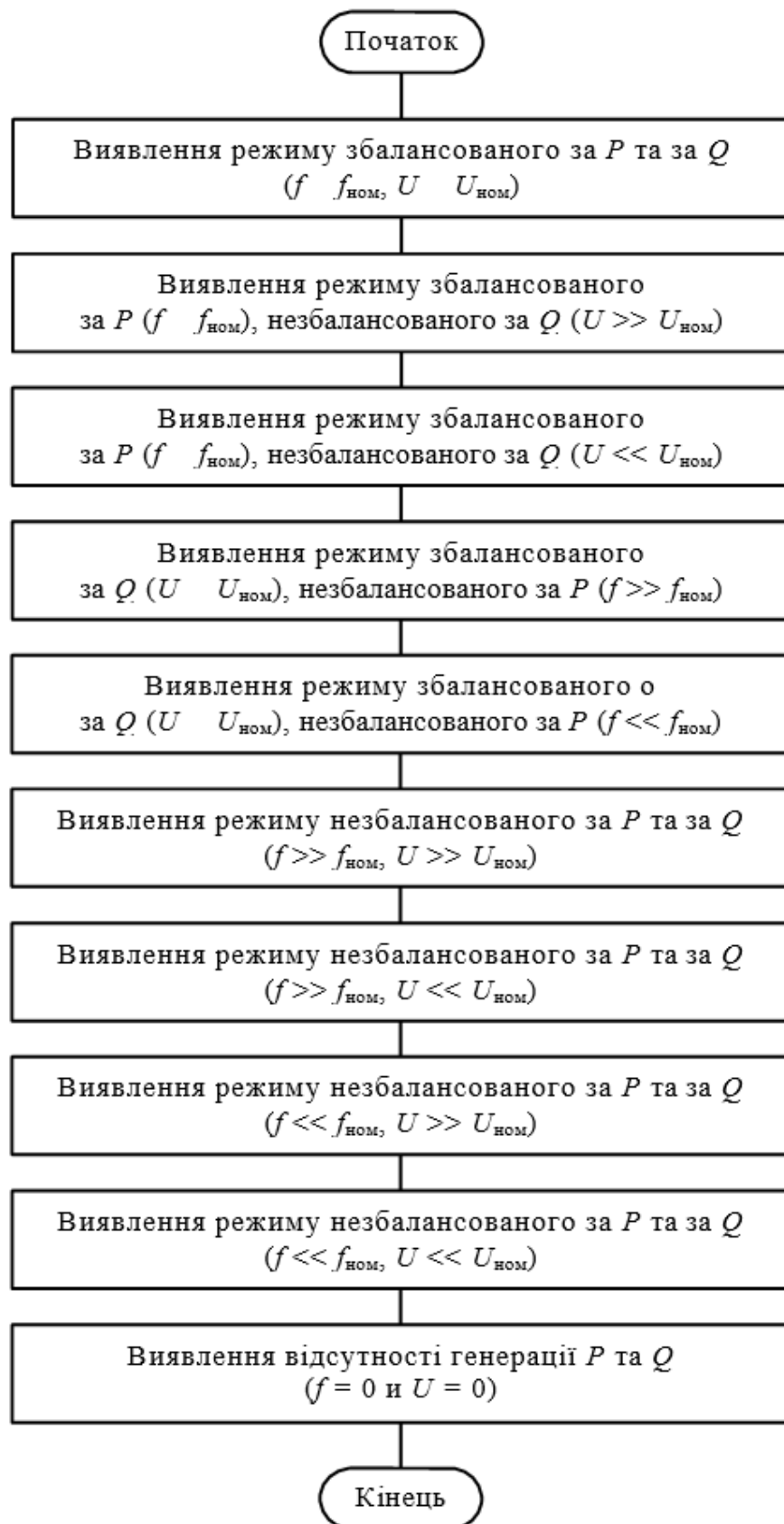
Рисунок 2.16 – Блок-схема алгоритму ідентифікації класу балансу потужностей загального виду
