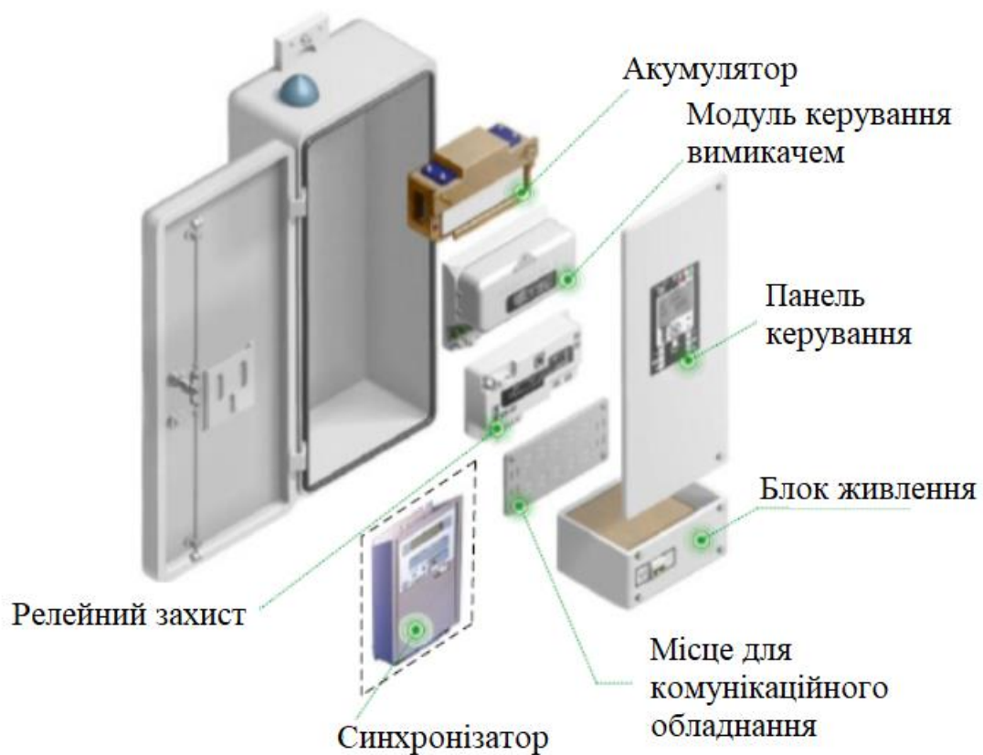
Рисунок 1.11 – Загальний вигляд шафи керування реклоузера із синхронізатором
